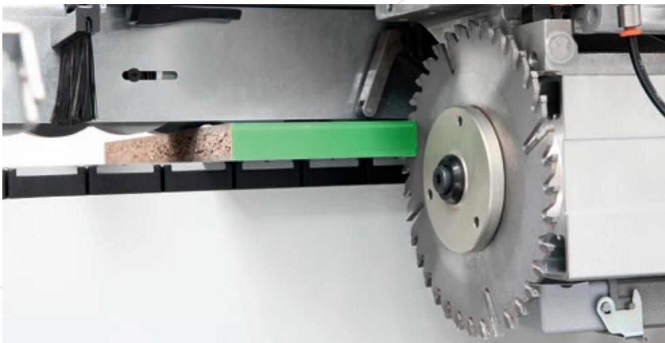
Fiabilité et précision de la coupe grâce au **Groupe de coupe** en bout pour éliminer la partie excédentaire du chant en tête et en queue du panneau. Le Groupe de coupe en bout prévoit de série le **Système Flex** qui permet de régler automatiquement la partie excédentaire du chant.
