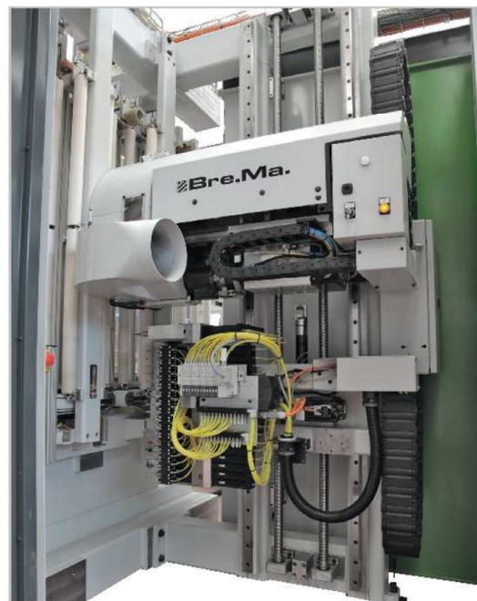
Gruppo revolver a 10 posizioni con gruppo mandrini indipendenti per lavorazioni di foratura, fresatura e pantografatura.
