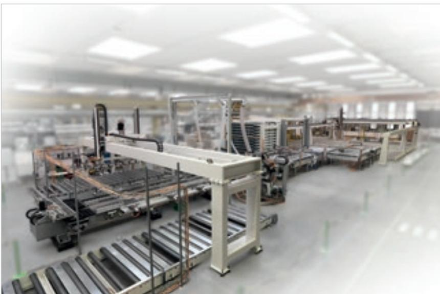
Installation Batch-One à magasins interopératoires (Buffer et Sorter) complètement intégrés.
