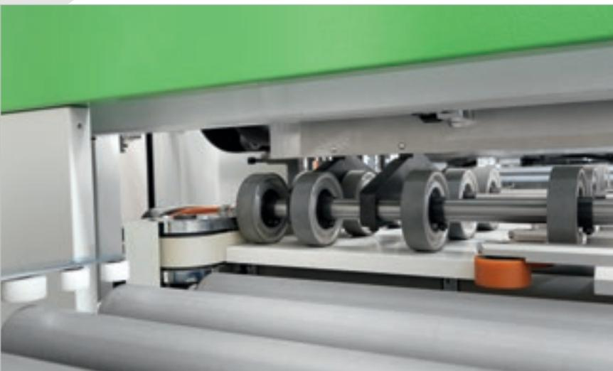
**Le système d'introduction combiné avec le presseur supérieur garantit une excellente tenue du panneau même pendant le perçage inférieur. Il permet également, grâce à l'action de la photocellule en entrée et au rapprocheur, d'obtenir le relevé automatique dimensionnel de la pièce.**
