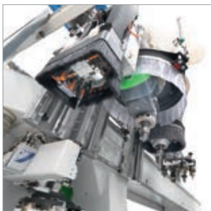
Unité de fraisage vertical de 6 kW.
