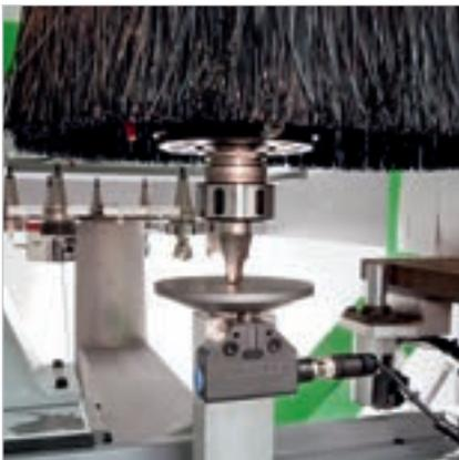
Réduction des temps d'outillage machine sans erreurs de la part de l'opérateur grâce au **Présélecteur à contact** qui permet de mesurer automatiquement la longueur de l'outil.
