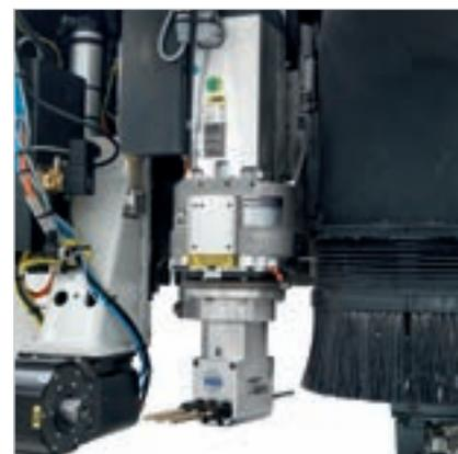
Le **groupe multifonction**, positionné en continu sur 360° depuis le CN, peut accueillir des agrégats pour l'exécution de façonnages spécifiques (logements pour serrures, logements pour charnières, perçage horizontal profond, coupe en bout, etc.).
