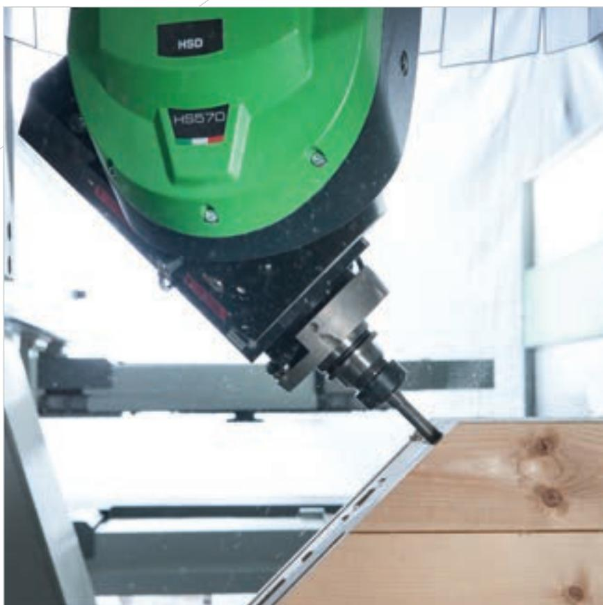
Nouvel **axe C Torque** : à système Direct Drive. L'absence d'engrenages assure une précision, une fiabilité et une rapidité d'exécution maximales. La rotation à 360° en continu et la possibilité d'interpoler permettent d'exécuter des pièces aux formes complexes.
