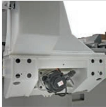
La double motorisation dans l'axe X permet d'atteindre des vitesses et des accélérations élevées tout en préservant une haute précision et une grande qualité de finition.
