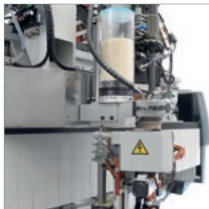
Le chargement de la colle est effectué en temps masqué dans le système d'alimentation granules solidaire au groupe d'encollage. En conservant la colle en granules et en gardant en fusion uniquement la quantité nécessaire au façonnage, on garantit la performance maximale de la colle qui conserve ses caractéristiques d'encollage.
