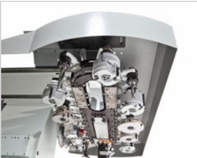
Il est possible de passer d'un usinage à l'autre, sans que l'opérateur doive intervenir pour changer l'outillage, grâce au nombre élevé d'outils et d'agrégats présents sur la machine.
