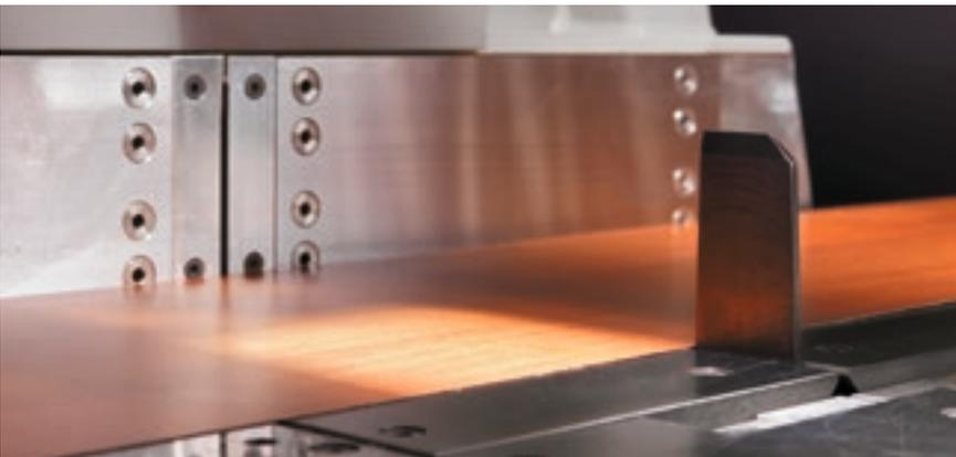
Alignement parfait de panneaux même très minces et/ou flexibles pour réduire au minimum le temps de cycle grâce à la **butée d'alignement latéral** intégrée au chariot porte-lames.
