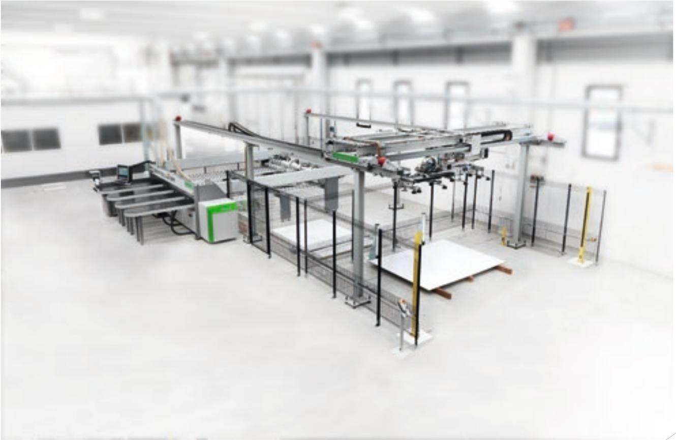
Le Winstore K3 permet de disposer à tout moment du panneau à usiner, sans changements de pile fréquents, et d'obtenir ainsi une augmentation considérable de la productivité de la cellule comparé à des solutions qui prévoient le chargement des piles par chariot élévateur.
