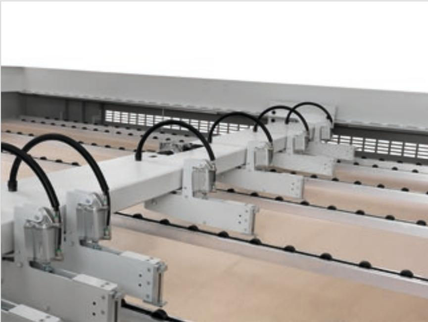
Les pinces, indépendantes et autonivelantes, assurent une prise solide des panneaux et l'éjection complète des piles coupées hors de la ligne de sciage.
