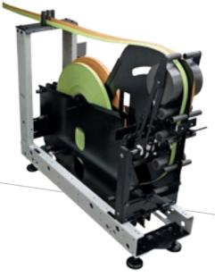
Réduction des temps d'outillage machine grâce au magasin à 2 positions pour l'échange automatique des chants en temps réel.
