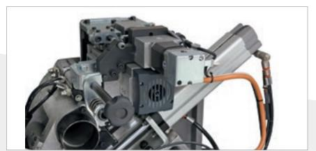
Le **Groupe arrondisseur** multifonction permet d'appliquer un rayonnage non seulement dans la partie supérieure et inférieure du panneau mais aussi sur la tête et la queue.
