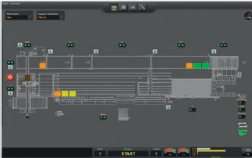
Le superviseur de ligne gère le flux de matériau au sein de la Stream B MDS et permet de connaître en temps réel l'état de la machine, la position et le nombre de panneaux ainsi que les phases d'usinage correspondantes.
