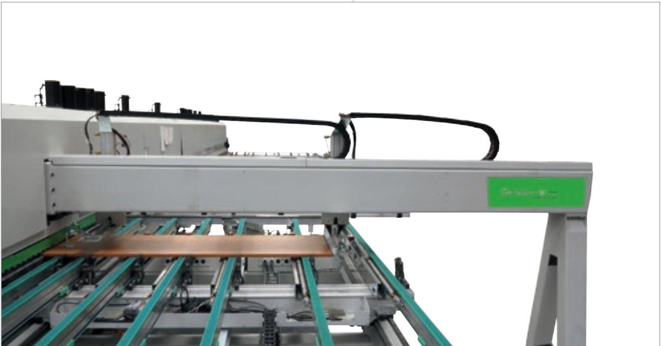
La plaqueuse de chants Stream B MDS 2.0 avec système d'introduction automatique représente le nec plus ultra en termes de flexibilité et d'automatisation. Elle peut être associée à un chargement semi ou entièrement automatique.
