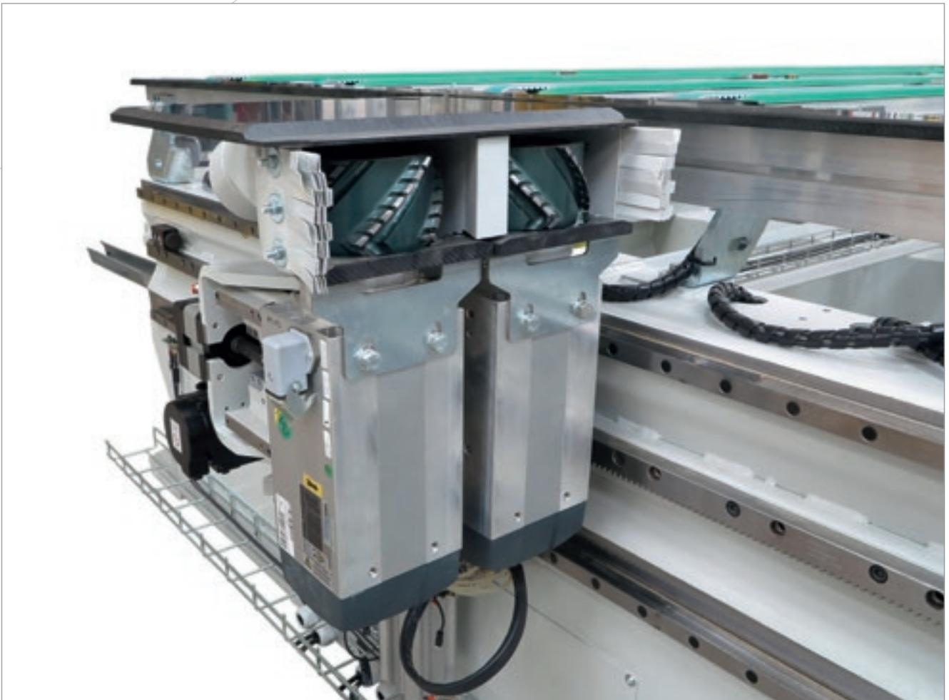
La rectification extérieure assure un parallélisme parfait des deux côtés longitudinaux. Les rails linéaires et la motorisation brushless garantissent des positionnements précis en temps réel entre une pièce et l'autre.
