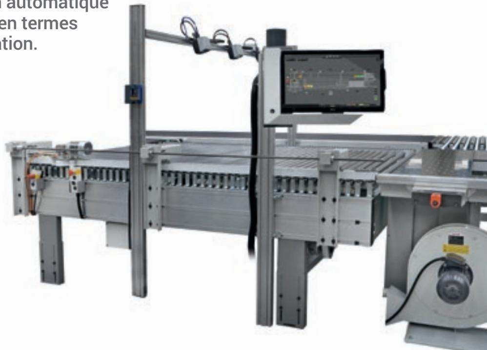
**Le module de façonnage est composé d'une zone d'introduction qui garantit une entrée parfaite du panneau dans la machine.**
