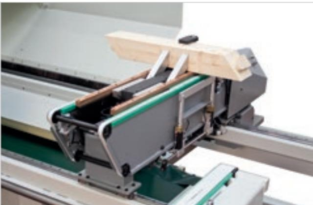
Le plan peut bloquer avec la même efficacité les pièces longues et les pièces courtes.
