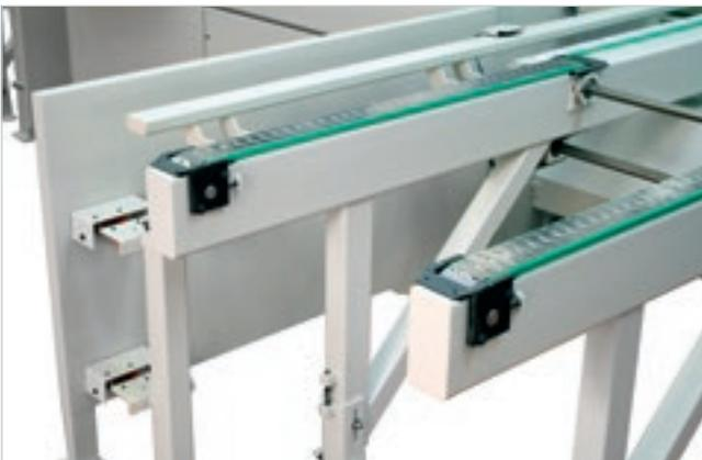
Le **tampon**, composé par des chaînes motorisées où peuvent être accumulés les pièces, permet d'alimenter automatiquement la machine en cycle continu, sans temps morts.
