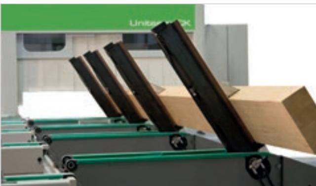
Le **système de rotation hydraulique** à 90° des étaux permet le façonnage des six faces de la pièce sans besoin de reprise.
