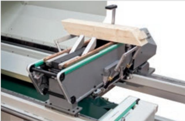
Le **système d'avancée de la poutre** se compose de quatre chariots dotés de système de blocage hydraulique vertical et horizontal.
