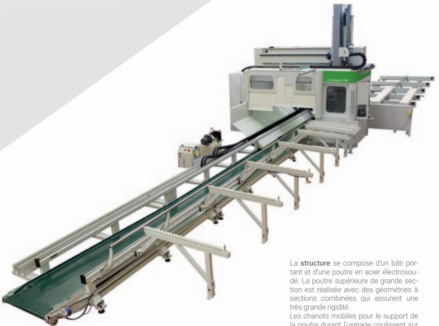
La **structure** se compose d'un bâti portant et d'une poutre en acier électrosoudé. La poutre supérieure de grande section est réalisée avec des géométries à sections combinées qui assurent une très grande rigidité.
