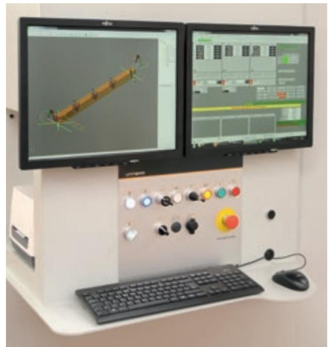
Le **logiciel CAO/FAO** utilisé sur les machines UNITEAM est idéal pour la conception de poutres droites et courbes. Réalisé spécialement pour le secteur, il simplifie l'utilisation de la machine en assurant une optimisation des processus et une augmentation considérable de la productivité.
