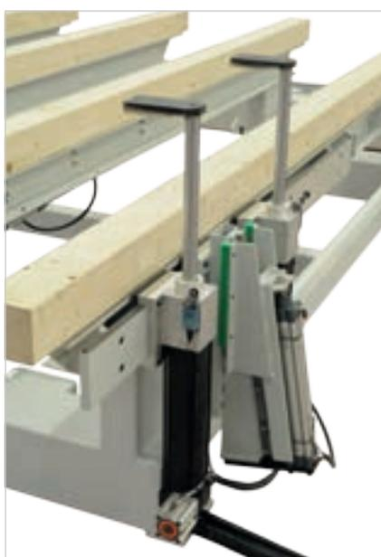
Les **étaux verticaux** permettent le blocage des éléments même avec une section réduite et augmentent la flexibilité de façonnage.
