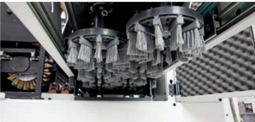
Le **Groupe Spinbrush** est la solution optimale pour le polissage également de composants réalisés avec des essences disposées dans différentes directions : l'enlèvement du matériau tendre de la veine du bois est effectué de manière uniforme dans toutes les directions grâce à l'oscillation de l'outil
