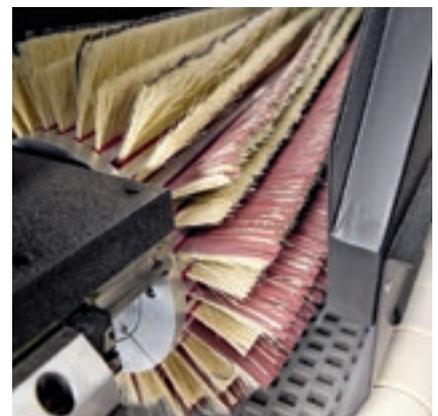
Le **groupe de brossage à inserts abrasifs** peut être muni d'un système d'oscillation transversale pour uniformiser la qualité de finissage du produit. Les poils abrasifs peuvent être rapidement remplacés sans devoir extraire le groupe de la machine.
