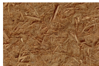
Fibre de bois - Panneau semi-rigide
