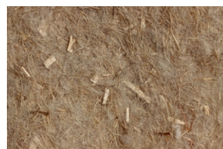
Fibre de chanvre - Panneau semi rigide
